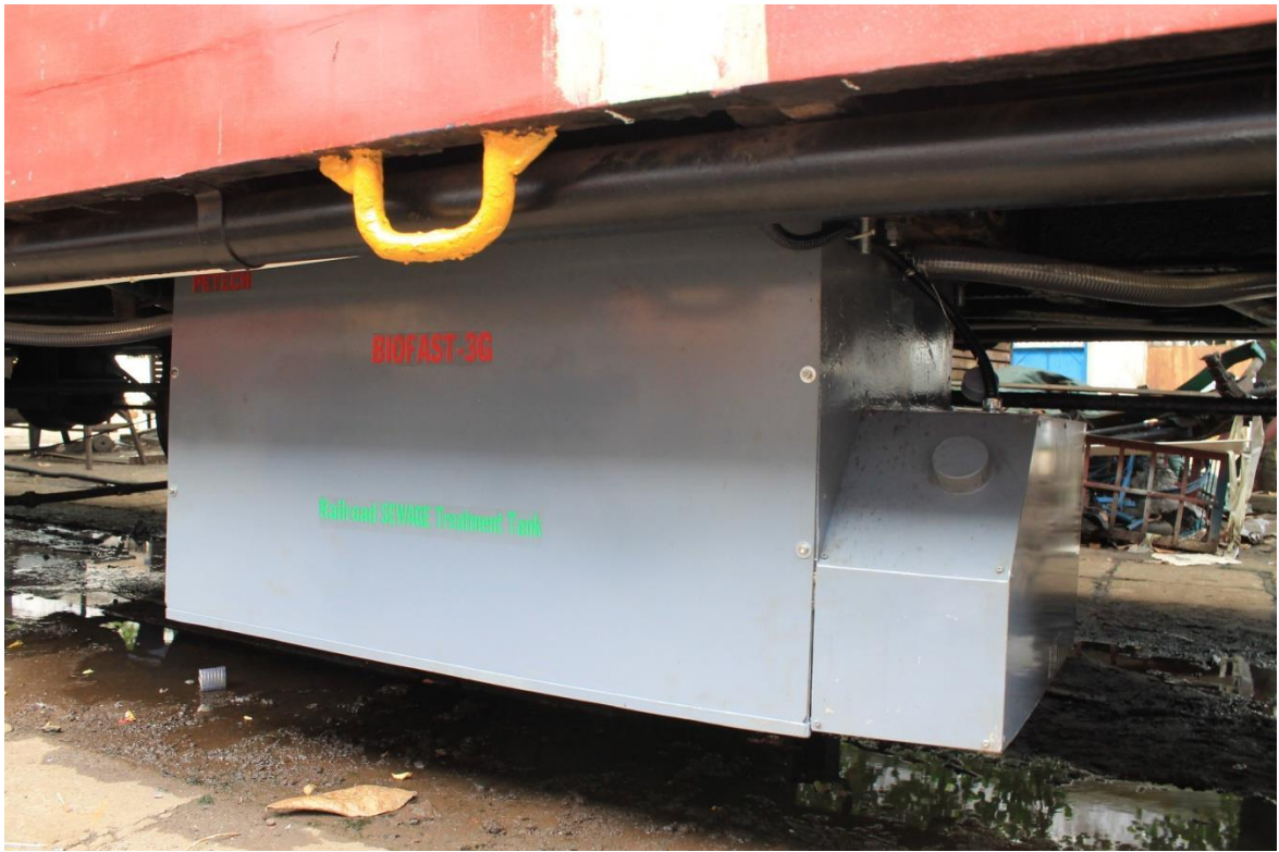
Bể xử lý tự hoại Biofast – 3G (Lắp trên toa xe A64 – 31349), ngày 12/9/2013.
