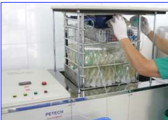
AMD-22 được thiết kế 2 cửa để nhân viên có thể đưa dụng cụ sấy vào mặt trước, lấy dụng cụ ra ở mặt trước /hoặc mặt sau máy ( tùy chọn) ,phù hợp với qui trình thiết kế một chiều của Khoa KSNK.
