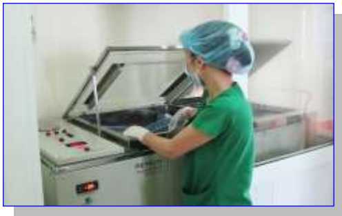
ASP-22 sử dụng công nghệ đóng gói tự động không can thiệp bằng thanh nhiệt – khí nén
