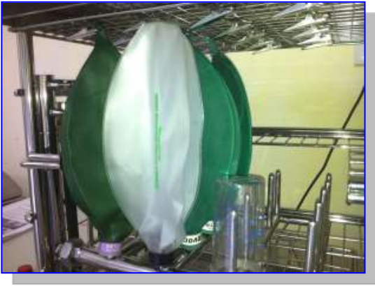
Khay đa năng trên AMC-22 có chức năng xử lý phun rửa sạch bên trong các loại bóng ambu, các bình, chai lọ đặc chủng của y tế ...
