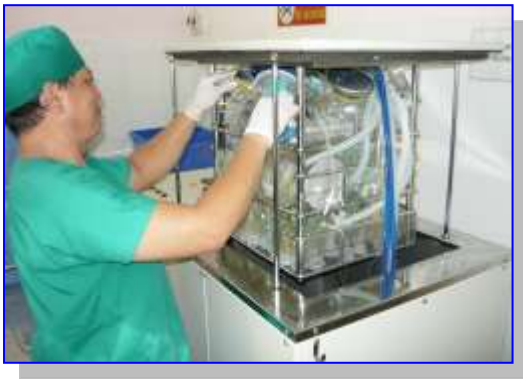
AMD-22 sử dụng công nghệ sấy khô chân không ở nhiệt độ thấp, bảo đảm luôn an toàn với mọi loại dụng cụ y tế
