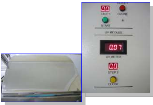
Hệ thống xử lý và kiểm soát tự động cường độ chiếu tia Uvc đa chiều
