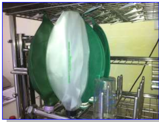
AMD-22 được thiết kế mới với khay chuyên dụng dành cho xử lý làm khô bên trong các chủng loại bóng Ambu và các loại bình, chai lọ y tế ...
