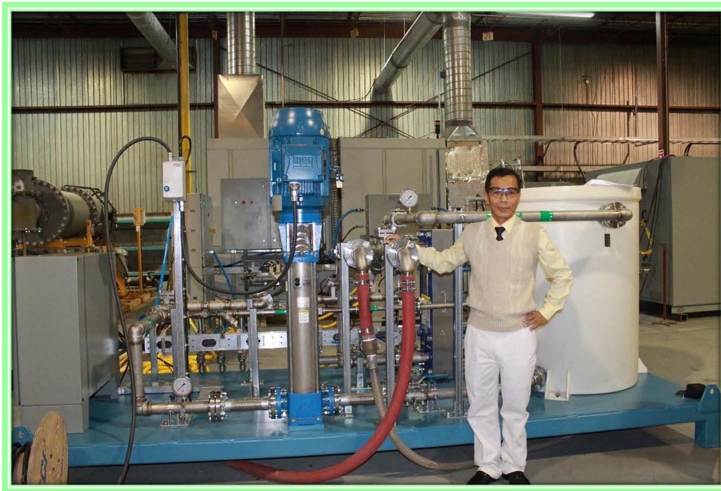
Thiết bị cấp nước làm mát cho hệ thống Plasma Torches (Sản xuất theo hợp đồng, cho nhà máy rác Plasma Đông Anh – Hà Nội)
